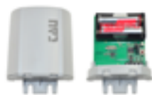
P-900TWC Trasmettitore slave wireless a batteria per bordo sensibile mobile/ fisso (gestisce fino a max. 2 bordi sensibili per TWC)
