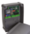
P-750D770M Quadro di comando per 1-2 motori 230 Volt con rallentamento e radio ricevente 433,92 MHz incorporata rolling code, completo di contenitore
